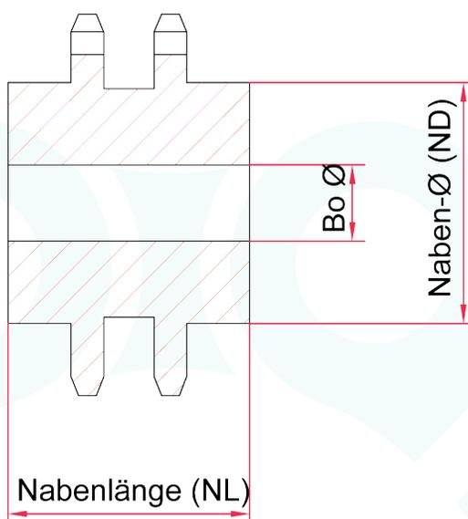
Zähnezahl: \_\_\_\_\_, Nabe angeschweißt / aus Vollmaterial gedreht
